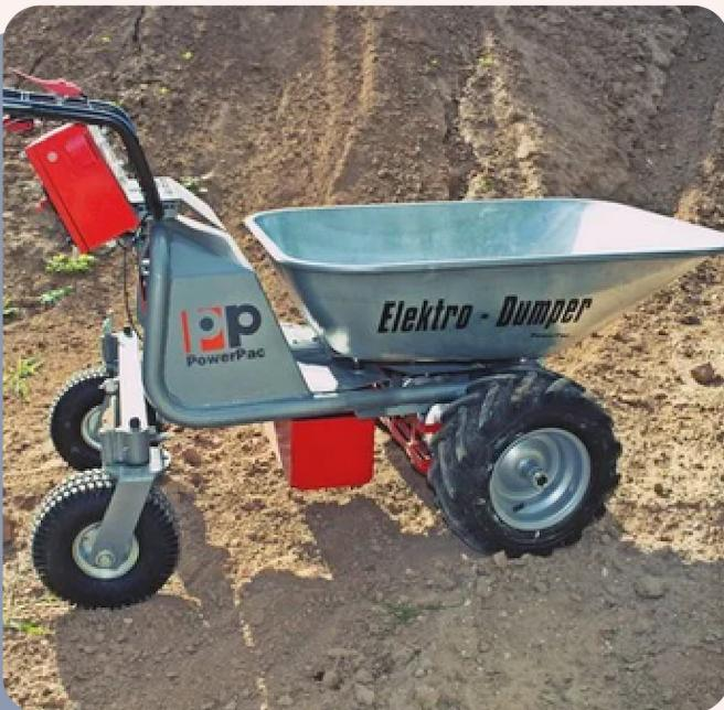
Dank des elektrischen Antriebs und der 4-Rad-Ausstattung wird nicht nur ergonomisches Arbeiten möglich, sondern es erhöht sich auch enorm die seitliche Standsicherheit, das Lenken gestaltet sich leichter und die Last verteilt sich besser.
